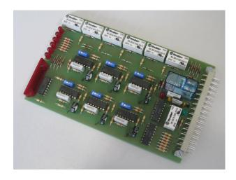
Die Alarmkarte AMK besteht aus einem Print in Europa-Format (160x100). Dieser ist steckbar ausgeführt, mit Stiftleisten 31-polig, nach DIN 41617. Die Montage erfolgt in Einzel-Stecksockel 31-polig oder in Racksystemen. Ein Griff an der Frontseite dient dem montieren bzw. demontieren der Karte, sowie der Beschriftung. Durch die modulare Bauweise können beliebig viele Alarmkarten parallel eingesetzt werden.
