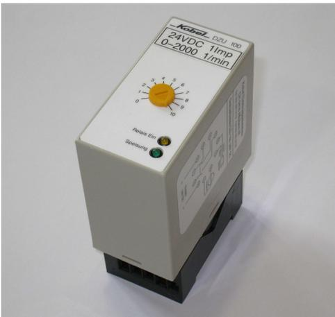
Das Drehzahlrelais DZU 100 wurde entwickelt, um eine kostengünstige, präzise Drehzahlerfassung / Auswertung für universelle Anwendung zu realisieren. Das Gerät ist als steckbare Einheit aufgebaut. Die Montage erfolgt in 11-poligem Industrie-Stecksockel. Die Elektronik ist in einem Norm-Kunststoffgehäuse untergebracht. Einstellung und Anzeige sind auf der Front übersichtlich angeordnet.
