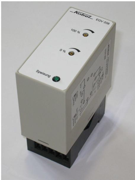
Der Eingangverstärker EGV 208 wurde entwickelt, um eine kostengünstige Wegmessung zu realisieren. Das Gerät ist als steckbare Einheit aufgebaut. Montage erfolgt in 11-poligem Industrie-Stecksockel. Die Elektronik ist in einem Norm-Kunststoffgehäuse untergebracht. Einstellung und Anzeige sind auf der Front übersichtlich angeordnet.
