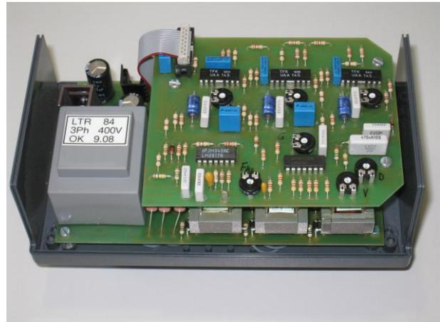
Mit dem LTR 3Ph - Lastregler wird die Drehzahl des Generators durch die Leistung gesteuert. Das heisst, bei steigender Drehzahl des Synchrongenerators, z.B. hervorgerufen durch das Abschalten von Lasten, steigt auch proportional zur Drehzahl die Frequenz. Da nun die Steuerelektronik frequenzabhängig ist, werden den Thyristoren grössere Impulse zugeführt und der Phasenanschnitt wird verlängert.
