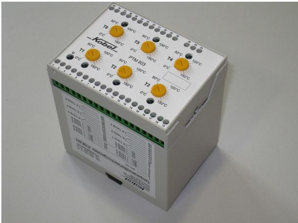
Das Temperaturüberwachungsgerät PTM 803 dient der Überwachung und Anzeige von PT-100-Temperatur-Messstellen 0-150°C. Das Gerät ist in einem DIN-Normgehäuse aufgebaut, zur Montage auf Hutschiene.
