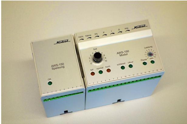
Der Wasserstandsregler AWS-150 dient der autom. Regulierung des Oberwasser-Niveaus. Er besteht aus zwei Teilen (Speisemodul und Reglermodul). Der Regler ist in ein DIN-Normgehäuse eingebaut, zur Montage auf einer Hutschiene.
